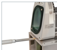
Præcis længdebestemmelse af elektrodens stick-out
